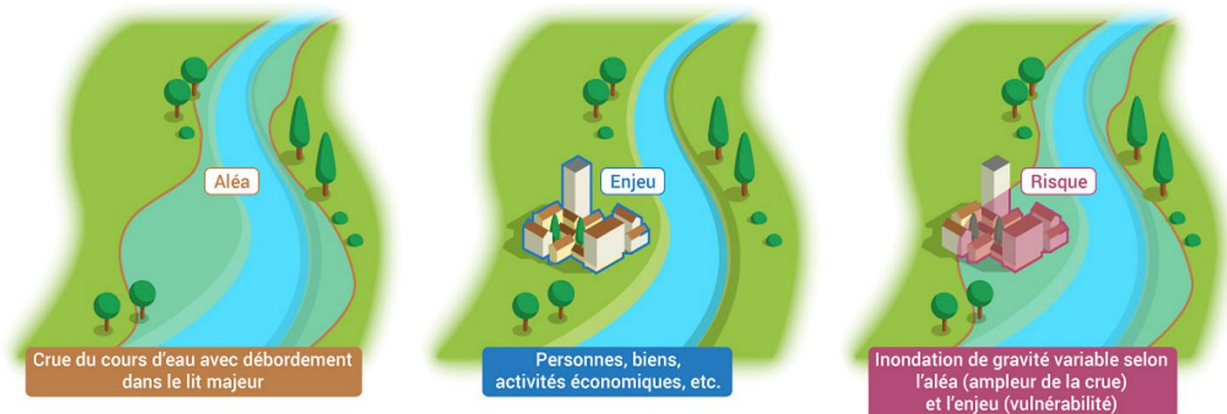
Figure 23 - Illustration des principes d'aléa, enjeu et risque (Source : Eaufrance)
