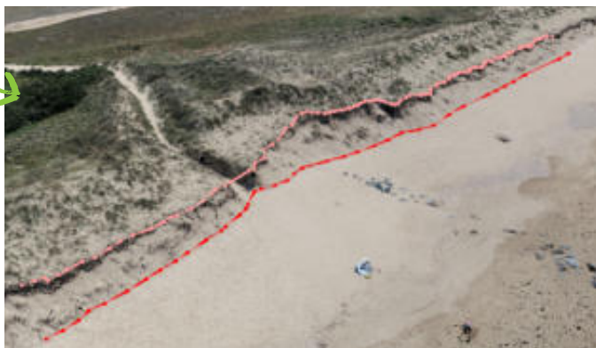
Relevé du trait de côte : en pied de dune (ligne rouge), en crête de dune (ligne rose)
