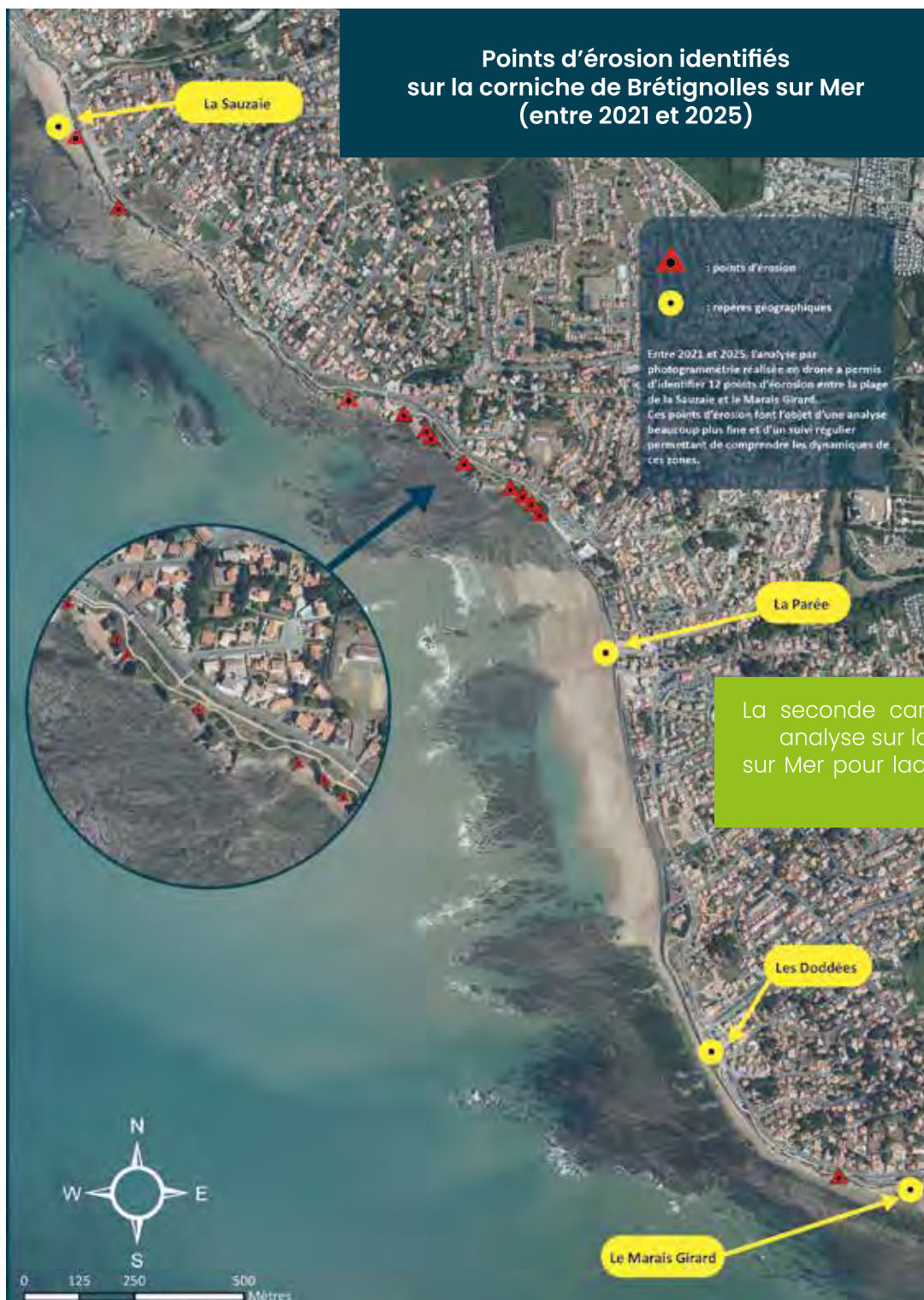
Carte 11 : Points d'érosion identifiés sur la corniche de Brétignolles sur Mer
