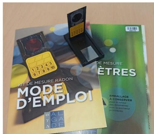
Figure 1 : Appareil de mesure du radon
